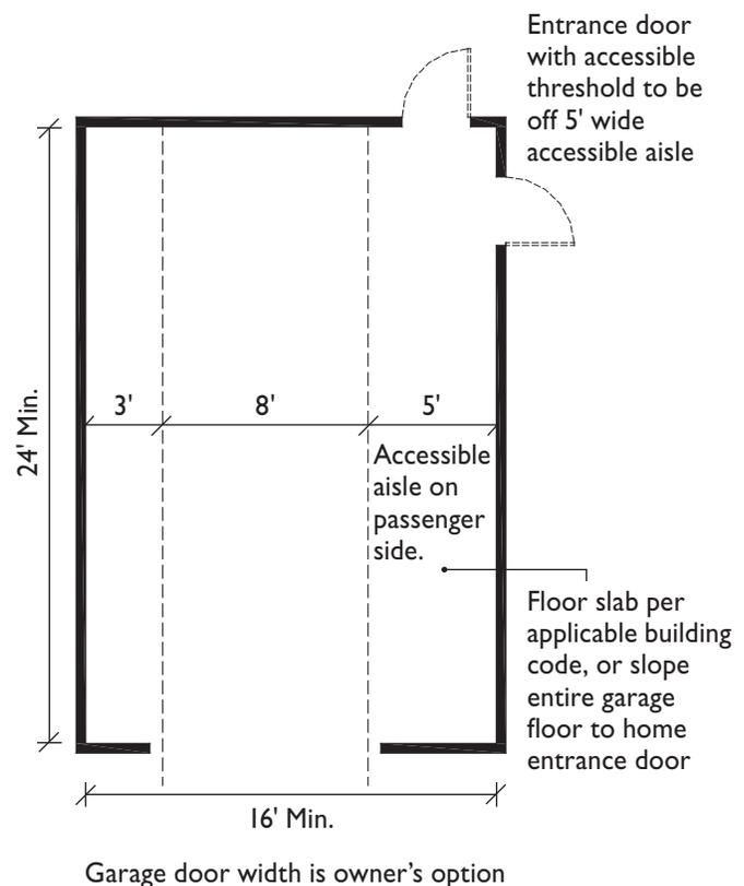
FIG. 103 OPT. 1 MINIMUM MEASUREMENTS ONE STALL GARAGE
